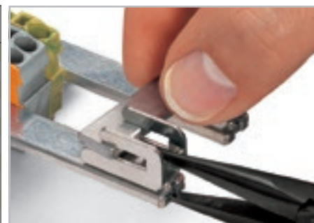
Для извлечения шины сожмите пружину с помощью плоскогубцев.
