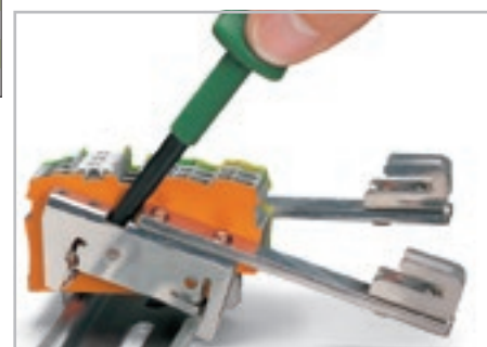
Снимите держатель шины с помощью рабочего инструмента, тип 3, лезвие 5,5 x 0,8 мм.
