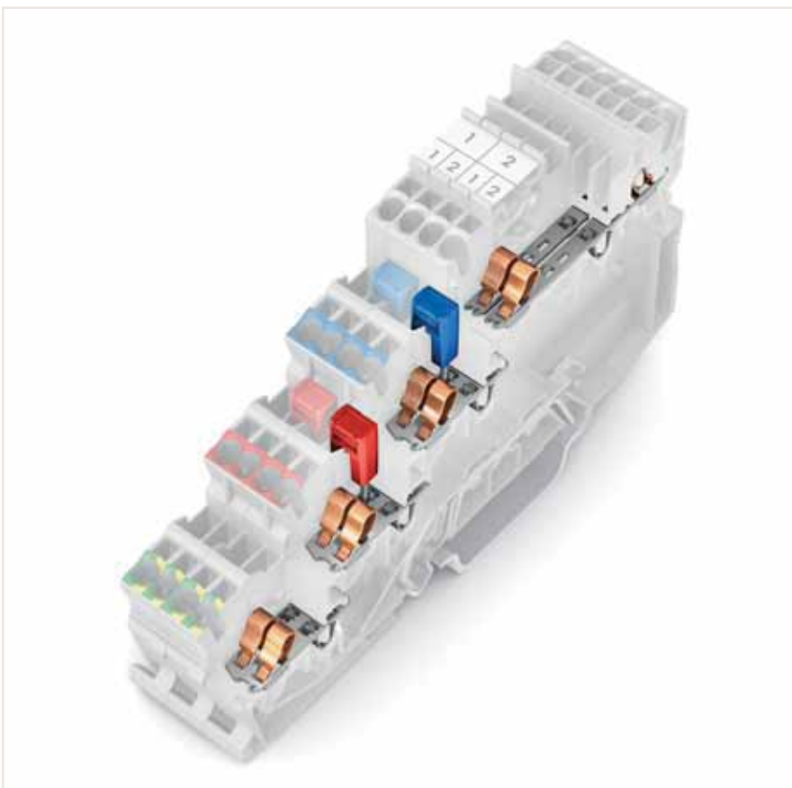
Верхний уровень: два независимых канала прохождения сигналов с шагом контактов 3,5 мм с двойным гнездом для перемычек Нижние уровни: два соединенных друг с другом зажимных устройства с общим потенциалом, с одним гнездом для перемычки, могут объединяться в любом направлении
