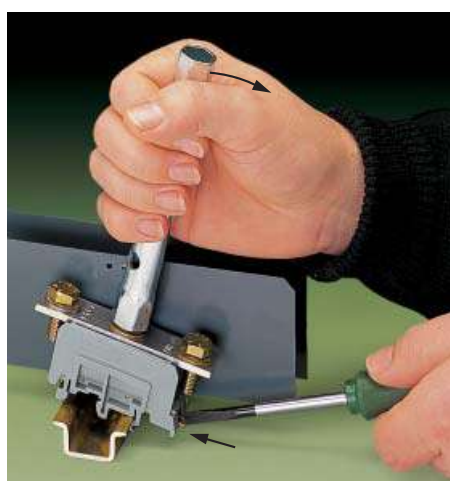
Демонтаж с DIN-рельса 35 мм
