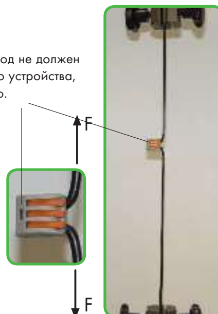
Схема испытаний для UL 486 C:
