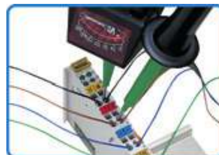
Проверка прохождения сигнала при подсоединенных проводниках
