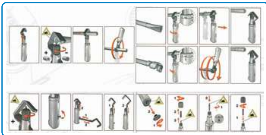
Инструкция по эксплуатации инструмента для зачистки кабелей 206-174
