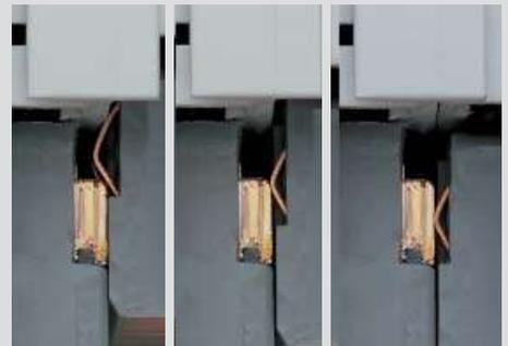
Безопасное, автоматическое соединение позолоченными, само-защитающимися скользящими контактами с высокой надёжностью контакта.
