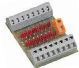
Модуль индикации без монтажного адаптера
