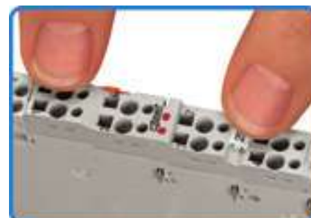
...вставьте разъем в модуль ввода-вывода.
