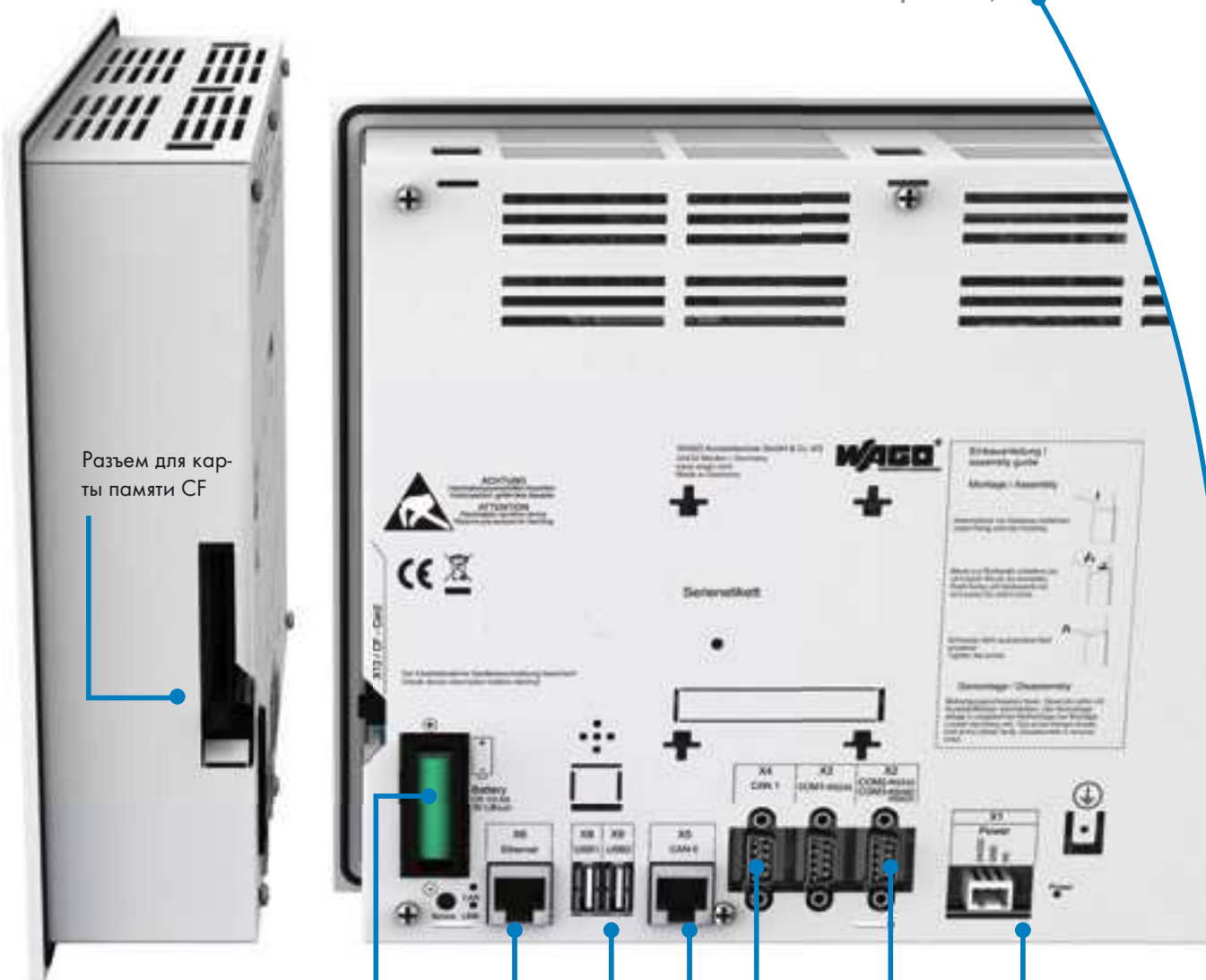
Батарея для буферизации данных в случае нарушения электропитания
