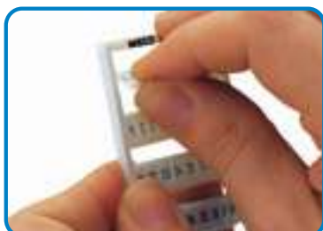
Отделение полоски от маркировочной карточки WMB
