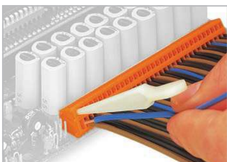
Подключение проводника с помощью рабочего инструмента
