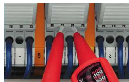
Функциональное испытание при помощи тестовых разъемов для проверки защиты от касания.
