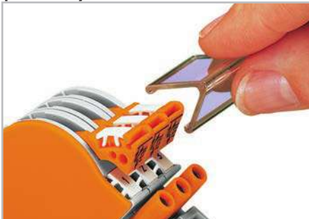
Защелкивающаяся прозрачная крышка на 1 – 8 размыкателей: а) Механическая блокировка нескольких размыкателей для схем коммутации с замыканием нескольких контактов б) Защита маркеров
