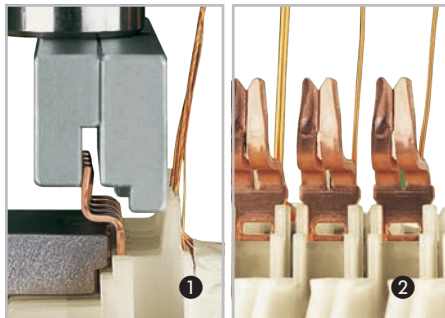
Окончательный монтаж контактов катушек:
