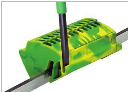
Разблокируйте правый и левый фиксаторы для снятия клеммы с заземлением. Затем снимите клемму со сборной шины.
