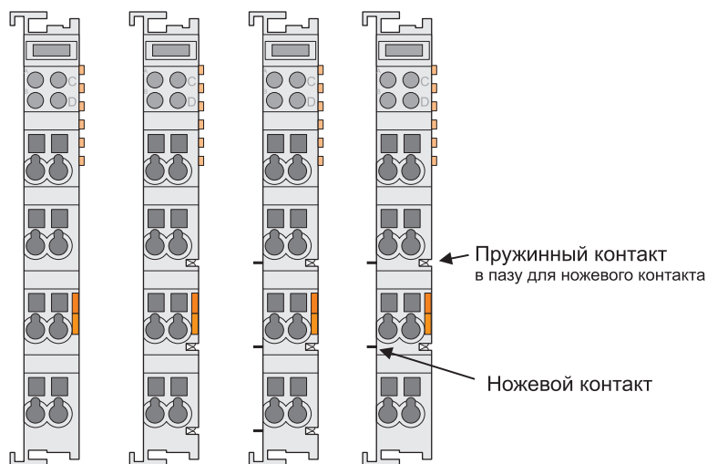
Рис. 2-8: Примеры расположения контактов питания
