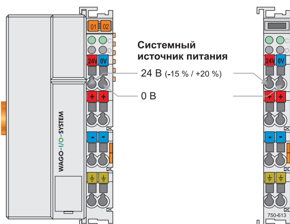
Рис. 2-11: Системный источник питания
