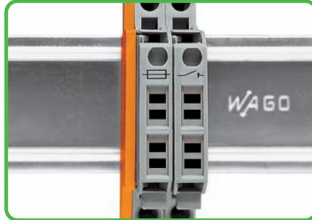
Клеммы с предохранителями или клеммы с предохранителями и размыкателями шириной 8 мм могут устанавливаться рядом. В конце монтажа, при **отсутствии** смежной клеммы с предохранителем или размыкателем, необходимо использовать торцевую пластину.
