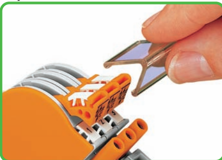
Надеваемая на разомкнутые линии (от 1 до 4) прозрачная крышка а) в качестве механического стопора для многополюсного переключения б) для защиты маркировки.
